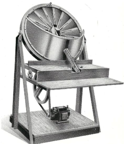
La compteuse comporte un disque tournant alimenté au centre par un magasin qui distribue des cachets ou des comprimés dans une glissière inclinée où ils glissent à plat jusqu'à une butée.
