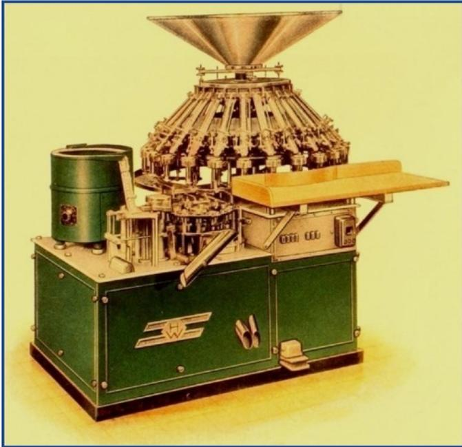
Cette machine compte les comprimés en tubes en vrac ou empilés, distribue automatiquement les bouchons en plastique ou les capsules métalliques et bouche les tubes.
